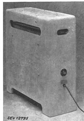
*Description:* Radiateur, selon figure, construit avec un matériau semblable à l'éternite. Le fil résistant, enroulé en boudin, est bobiné sur 3 tiges en matière céramique, montées horizontalement dans un bâti ventilé. L'intérieur du bâti est subdivisé par des plaques verticales. Cet appareil possède un interrupteur de réglage encastré. Le cordon d'alimentation, constitué par un cordon torsadé muni d'une fiche 2P+T, est fixé à demeure.
