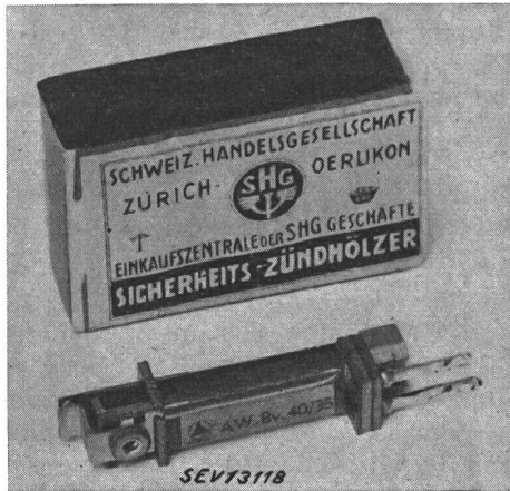
Fig. 5. Miniaturrelais des Impulswiederholers (Grössenvergleich mit einer Streichholzschachtel)
