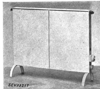
**Description:** Radiateur selon figure. La résistance de chauffe est logée dans deux tubes de fer coudés en forme de U et montés dans la partie inférieure d'un boîtier ventilé (paroi chauffante) en tôle d'aluminium. L'interrupteur de réglage et la fiche d'appareil sont fixés sur un côté, au bas de l'appareil.
