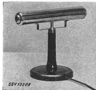
**Description:** Appareil selon figure, pour régénérer le papier carbone par voie thermique. Le corps de chauffe est monté dans un tube métallique nickelé, fixé sur un socle en bois. Le cordon d'alimentation, constitué par un cordon rond à deux conducteurs muni d'une fiche, est fixé à demeure. Le papier carbone à régénérer est passé, en l'appuyant, sur l'appareil.
