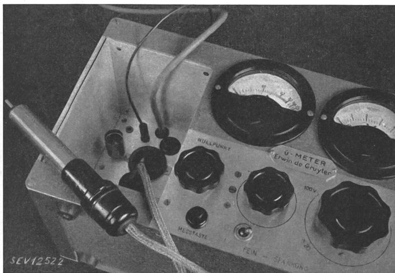
Fig. 13. Ansicht eines Kompensations-Röhrenvoltmeters mit eingebautem Netzanschlussgerät
