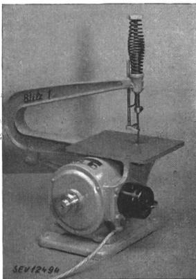
**Description:** Petite scie mécanique, selon figure, entraînée par un moteur monophasé blindé à induct en court-circuit avec phase auxiliaire. Mise en marche par un interrupteur avec position de démarrage, fixé au bâti; raccordement au réseau par un cordon torsadé à trois conducteurs, muni d'une fiche 2P+T.
