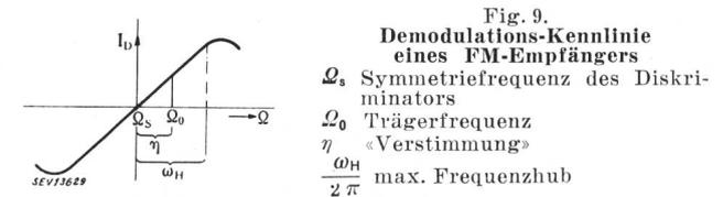
Wenn die Trägerfrequenz gegenüber der Symmetriefrequenz  $\Omega_s$  des Diskriminators abweicht, errechnet sich das Verhältnis des Störfaktors  $S$  zu demjenigen bei idealer Einstellung  $S_i$  zu:
