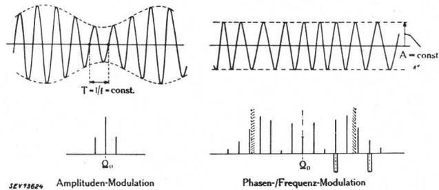
SEV 13624 Amplituden-Modulation SEV 13624 Phasen-/Frequenz-Modulation
