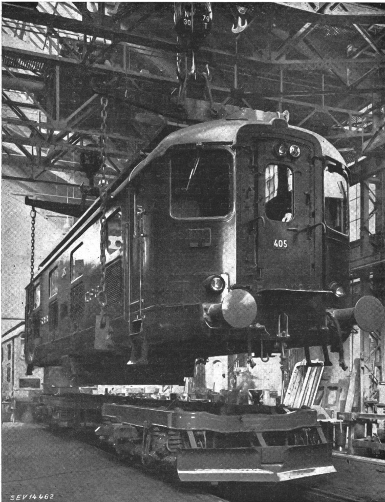
Zusammenbau der SBB-Leichtschnellzugs-Lokomotive Re 4/4
