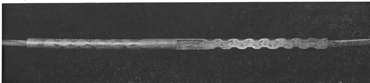
Fig. 18 Fertige Alutherm-Schweißverbindung mit Rohrverbinder (teilweise aufgeschnitten)
