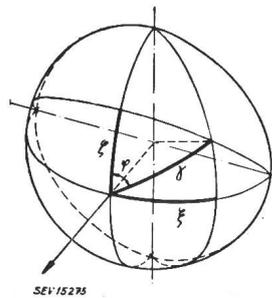
Fig. 4 Zur Ermittlung des Lichtstromes im beschränkten Raumwinkel
