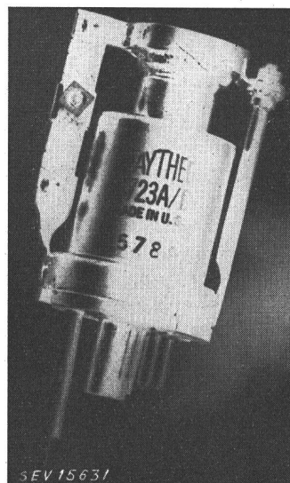
Fig. 2 Klystron elektronische Laufzeitöhre zur Erzeugung von Zentimeterwellen
