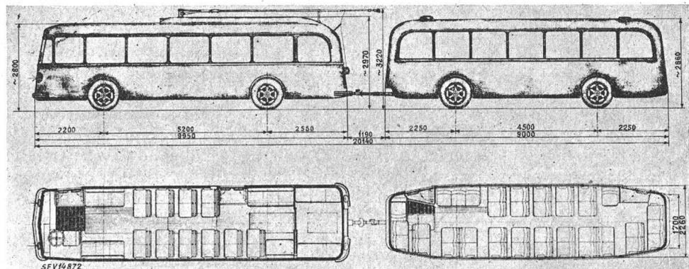
Seitdem es gelungen ist, durch eine Deichsel angekuppelte vierradgelenkte Anhänger zu bauen, welche nicht nur im Profil des Triebfahrzeuges genau spuren, sondern auch bei allen Geschwindigkeiten und allen Lenkmanövern des Triebfahrzeuges einen sicheren und ruhigen Lauf ohne gefährliche
