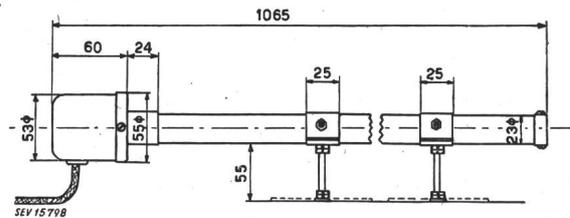
axialement. Cordon torsadé à trois conducteurs avec fiche 2 P + T, introduit par une entrée isolante dans un coffret protégé-bornes et fixé par une bride.
