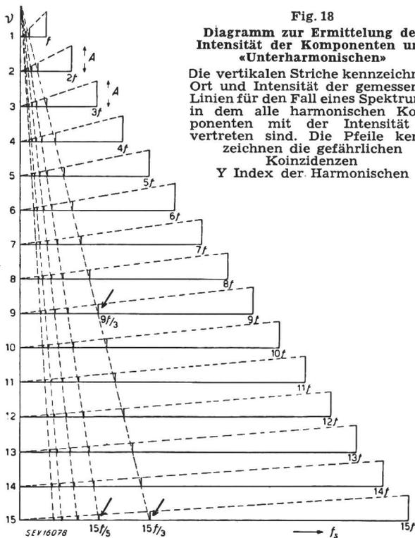
Vertikalstriche, d. h. der Intensität  $A/\nu_s$ , ist aus dem Diagramm leicht ersichtlich. Da man die Grundfrequenz  $f$  der zu analysierenden Spannung immer kennt, weiss man, wo «Hauptlinien» und wo «Satelliten» im Spektrum zu erwarten sind. Letztere werden stören, wenn sie mit einer Hauptlinie zusammenfallen, im Diagramm also auf einer vertikalen Linie liegen. Der gefährlichste Fall ist das Zusammentreffen von  $f_s = 9f/3 = 15f/5$  mit  $3f$ .
