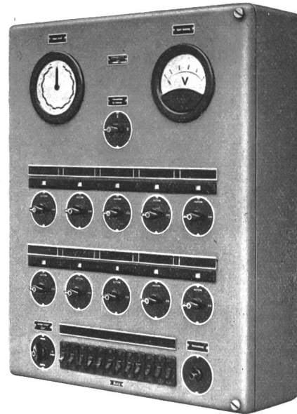
Fig. 2 Kommandogerät für einfachere Schaltprogramme (10 Doppelbefehle mit automatischer Steuerungsmöglichkeit durch beliebige Schaltuhren und zusätzlich 12 Doppelbefehle für reine Handsteuerung)
