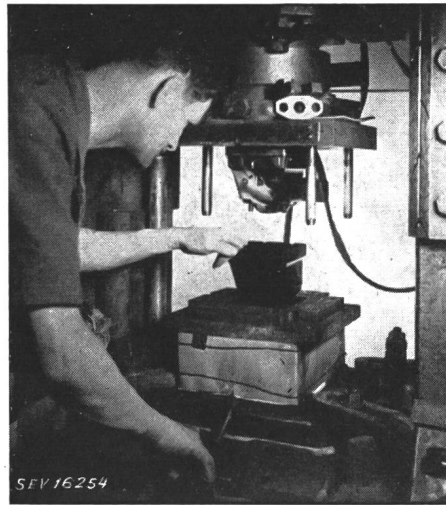
Fig. 2 Pressen des Isolierstoffgehäuses eines Telephonapparates
