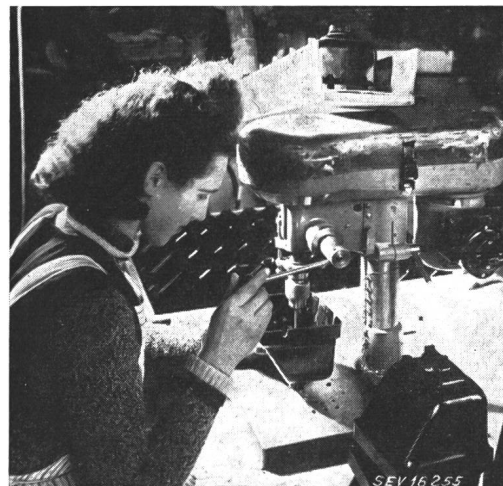
Fig. 3 Verputzen des fertig gepressten Gehäuses des Telephonapparates
