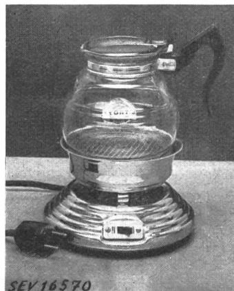
deux allures de chauffe. Enveloppe extérieure et socle en tôle de laiton chromée, pieds en matière isolante moulée. Cordon de raccordement rond fixé à l'appareil, avec fiche 2 P + T.
