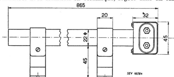
en métal léger, muni de deux pieds pouvant être déplacés axialement. Fiche d'appareil pour cordon de raccordement.
