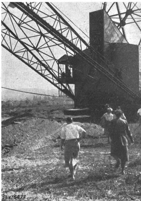
Fig. 4 Die Maschinenkabine des amerikanischen Riesebaggers Links das Führerhaus. Der Kran wird normal von 2 Mann bedient
