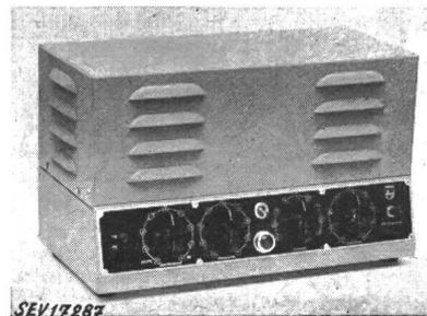
lateur d'entrée et touche de sélection de programmes de télédiffusion. Régulateurs d'intensité et de tonalité. Commutateur gramophone-télédiffusion. Translateur de sortie avec 6 prises.
