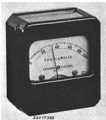
Fig. 1. Taschenluxmeter mit eingebauter Selenphotozelle und Mikroampèremeter
