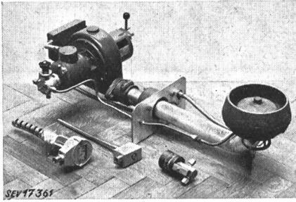
œuvre par thermostat de cheminée «Richiger» et thermostat de chaudière «Sauter», qui actionnent un disjoncteur de protection du moteur «Sauter» télécommandé et une soupape à mazout «Knoll». Coffret avec bornes montées sur support en matière céramique.
