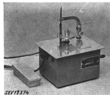
velle. Deux porte-électrodes peuvent être enfilés sur des boulons de connexion. Cordon de raccordement à trois conducteurs sous double gaine isolante, avec fiche 2 P + T. Circuit primaire commandé par interrupteur à pédale ou par bouton-poussoir incorporé. Poids du transformateur sans les accessoires 16,2 kg.
