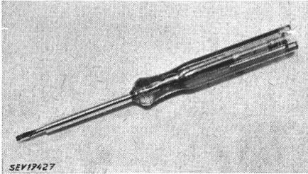
une petite lampe et une résistance de protection. Electrode en métal moulée dans l'autre extrémité du manche. La longueur du manche est de 130 mm et celle de la lame de 90 mm. La lame est enrobée de matière isolante sur une longueur de 70 mm.
