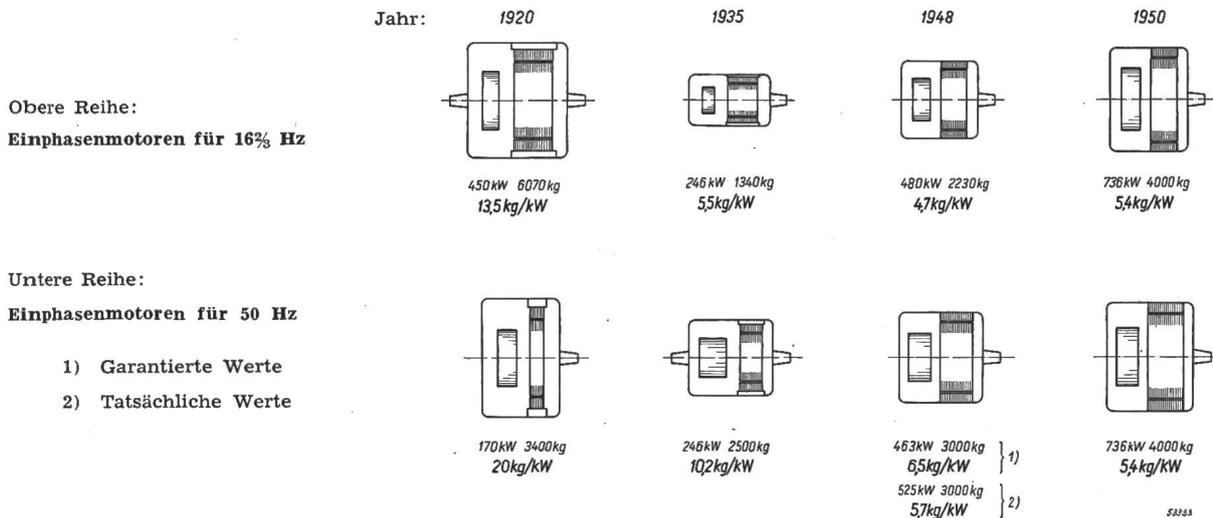
Fig. 10 Vergleich der Entwicklung von Einphasen-Triebmotoren für  $16\frac{2}{3}$  und 50 Hz im Zeitraum von 1920...1950
