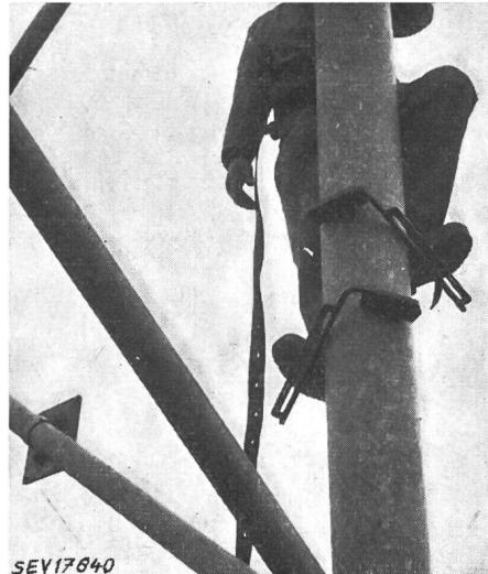
Fig. 6 Grimpettes pour pylônes en tubes d'acier Ces grimpettes peuvent être facilement adaptées aux différents diamètres de tubes
