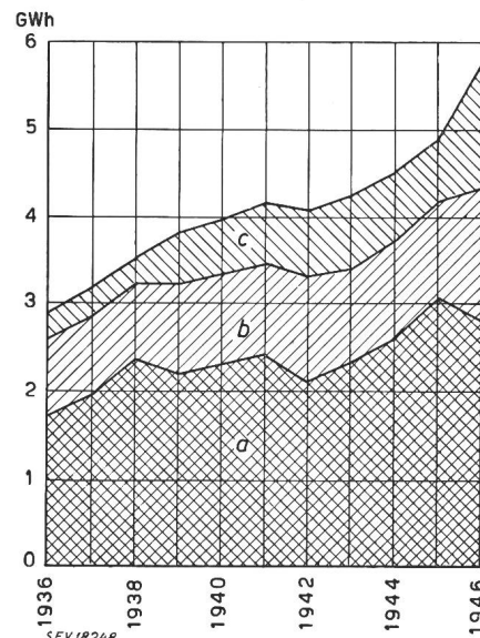
Fig. 3 Portugiesische Elektrizitätserzeugung a Wärme- kraftwerke b Laufwerke c Speicherwerke } Wasserkraftwerke
