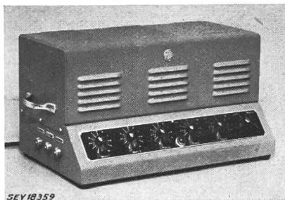
renfermant le dispositif de raccordement au réseau, l'amplificateur et les organes de réglage. Translateur de sortie avec
