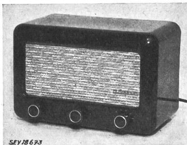
haut-parleur séparé. Transformateur de réseau à enroulements séparés. Protection contre les surcharges par deux petits fusibles précédant l'anode du tube redresseur. Côté primaire du translateur d'entrée relié au châssis. Boîtier en matière isolante moulée, avec paroi arrière en presspahn. Cordon de raccordement rond, fixé à l'appareil, avec fiche. Deux jeux d'alvéoles de 6 mm pour le raccordement au circuit téléphonique et le raccordement d'un haut-parleur séparé.
