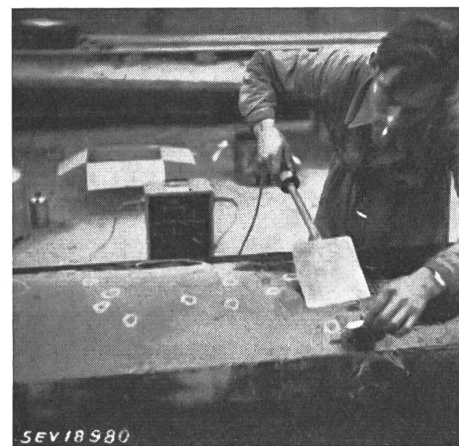
Fig. 4 Contrôle électrique à haute tension d'une isolation «Vetro-Waberit» Les endroits poreux décelés par l'arc sont marqués à la craie puis refondus au chalumeau (Strassenbaumaterial A.-G., Berne)
