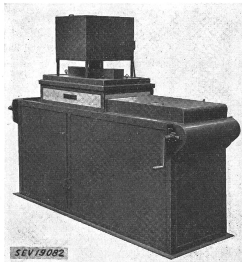
Fig. 11 4-kVA-Strahlungsofen zum Einbrennen von Transparentlack auf vergoldeten Uhrenbestandteilen
