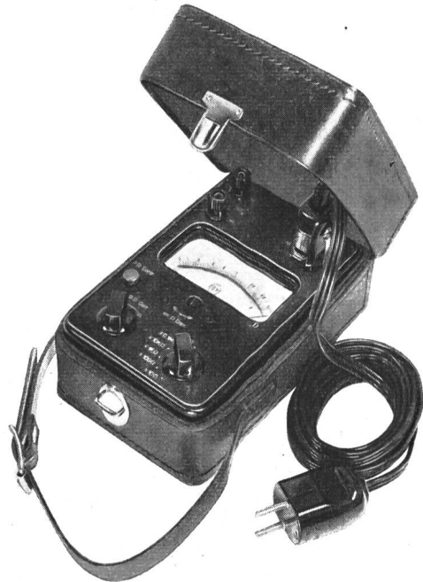
Fig. 5 Universal-Isolations- und Widerstand-Messgerät Ohmi
