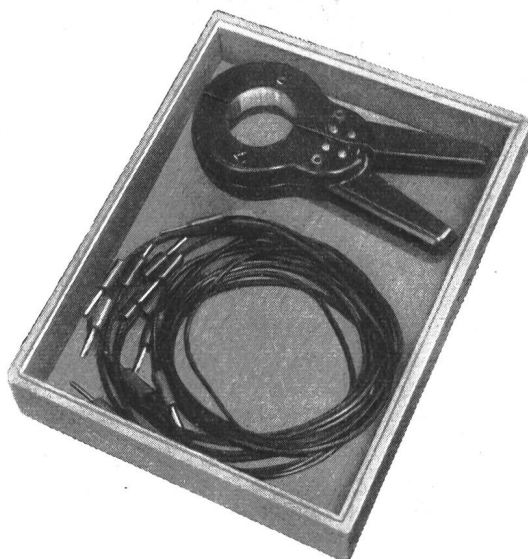
Fig. 3 Blindboden des Vancos-Meters für Zangenwandler und Anschlusskabel
