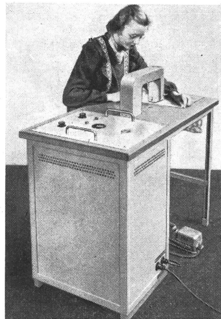
Fig. 1 Plastic-Näh-Schweissmaschine (HF-Generator für dielektrische Heizung)
