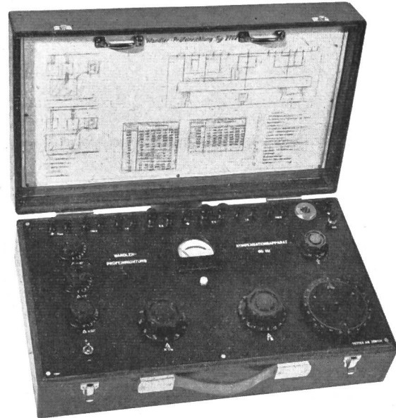
Fig. 1 Strom- und Spannungswandler-Prüfeinrichtung Kompensationsapparat, Typ 2701
