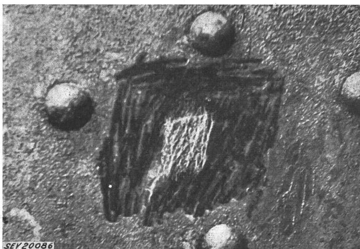
nischen Einwirkung des Wasserstrahles ausgesetzt sind, einer Abnutzung unterworfen (Fig. 2). Die zum Vorschein kommende helle Zinkschicht kann
