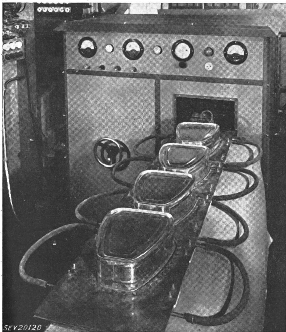
Fig. 10 Verlöten von Konservbüchsen Vier von den in Fig. 9 abgebildeten Kupferplatten werden in Serie als Arbeitsspule verwendet
