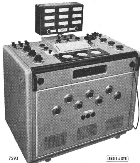
Fig. 3 Eichstation «Metrabloc» für Elektrizitätszähler
