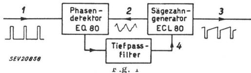
Blockschema der Schwungradsynchronierschaltung
