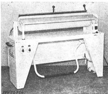
du tambour par moteur triphasé blindé, à induit en court-circuit, avec courroies trapézoïdales et réducteur de vitesse. Bâti en tôle. Interrupteurs pour le chauffage et le moteur. Lampe-témoin. Relèvement de la plaque chauffante par pédale. Poignées isolées. Cordon de raccordement à quatre conducteurs, fixé à la machine, avec fiche 3 P + T.
