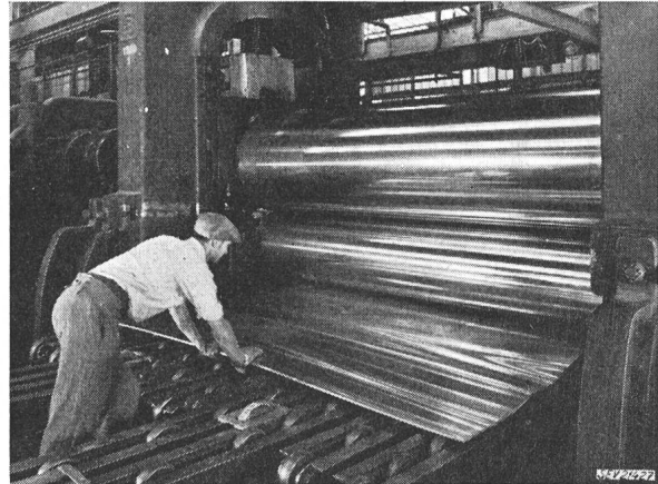
Aluminium-Industrie A.-G. in Chippis Kaltwalzen eines Konstruktionsbleches auf dem 3-m-Achenbach-Kaltwalztrio
