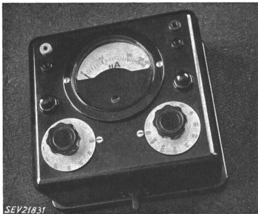
Fig. 11 Tonfrequenz-Spannungs- und Strommesser mit Graetz-Kontaktgleichrichter
