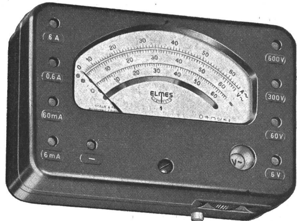
Fig. 1 «Elmes 1» Instrument universel résistant aux chocs, 30 domaines de mesure
