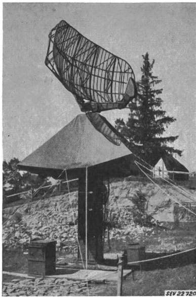
Fig. 20 Flab-Such- und Zielzuweisungs-Radargerät Reichweite ca. 100 km (USA/Italien)
