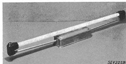
avec couvercle vissé. Presse-étoupe ou tubulure filetée pour l'introduction de l'amenée de courant. Douilles en matière isolante moulée, reliées au boîtier par des tubes métalliques. Starter à effluve dans l'une des douilles. Ce luminaire est également livrable avec douilles en porcelaine.
