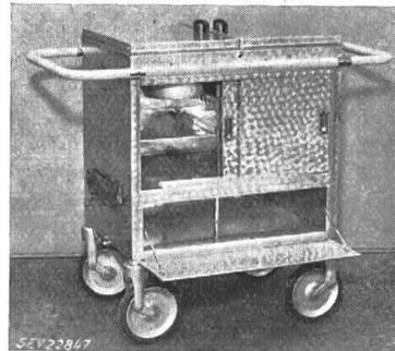
de chauffe à isolation au mica et gaine de tôle, logés verticalement au centre de la servante. Thermostat avec positions de réglage et lampe témoin. Bâti à double paroi en métal léger avec calorifugeage. Poignées isolées. Cordon de raccordement à trois conducteurs isolés au caoutchouc, fixé à une boîte de raccordement.
