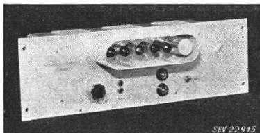
de sortie à enroulements séparés. Régulateur de volume et prises de contrôle BF. Transformateur de réseau à enroulements séparés, commutable. Protection par deux petits fusibles en amont des anodes du tube redresseur. Appareil prévu pour encastrement, avec fermeture arrière par couvercle perforé.
