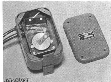
chrone. Amenée de courant à trois conducteurs pour le moteur synchrone et la mise à la terre du coffret. Amenée de courant à deux conducteurs (1,5 mm<sup>2</sup>) pour le micro-interrupteur.
