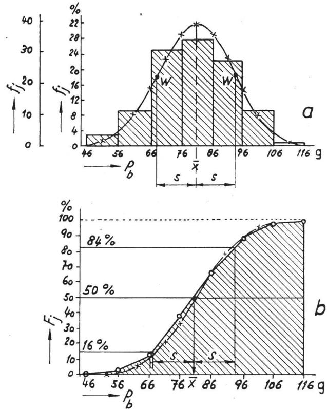
Fig. 1 Diagramme des fréquences a et diagramme des fréquences cumulées b pour la détermination de la résistance d'un fil textile
