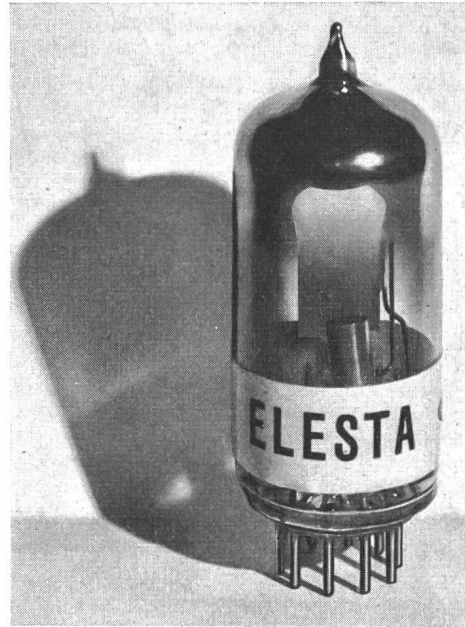
Fig. 1 Kalkkathodenröhre für Gleich- und Wechselstrom
