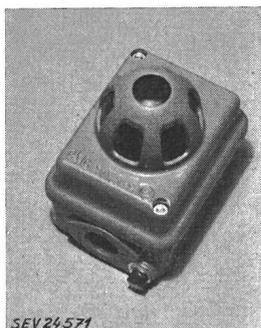
Cette lampe témoin est conforme aux «Prescriptions pour douilles de lampes» (Publ. n° 167 f) et au quatrième projet des «Prescriptions pour matériel d'installation et appareils électriques antidéflagrants». Utilisation: dans des locaux mouillés et présentant des dangers d'explosion par des gaz et vapeurs du groupe C. Classe d'explosion 2.
