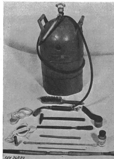
Fig. 6 3) Outillage et matériel pour le soudage d'après la méthode «à réaction»
