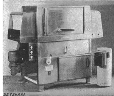
casse ventilée, à induit en court-circuit. Barreaux chauffants pour le chauffage de l'enceinte. Contacteurs de couplage avec déclencheurs thermiques, interrupteurs pour le chauffage et les moteurs, lampes témoins et socles de coupe-circuit. Chauffe-eau à accumulation avec thermostat et contacteur de couplage adossé. Bâti de la machine en acier inoxydable. Poignées isolées. Machine prévue pour montage à demeure des amenées de courant et des conduites d'eau.
