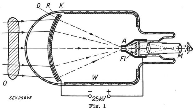
Fig. 1 Schematische Darstellung der Bildverstärkerröhre
