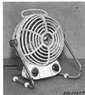
Radiateur soufflant «Astron 2000», selon figure, utilisable comme radiateur et ventilateur. Résistance boudinée fixée à un support étoilé en mica. Ventilateur entraîné par moteur monophasé série, autodémarreur. Fonctionnement possible avec air froid, tiède ou chaud, avec ventilateur tournant à quatre vitesses différentes. Lorsque le moteur est bloqué, le chauffage est déclenché par un thermostat incorporé. Commutateurs pour
