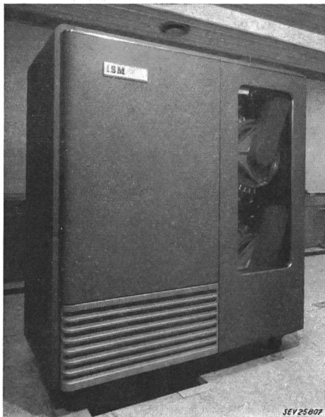
Fig. 7 Speichereinheit mit zwei Magnettrommeln
