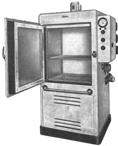
Fig. 4 «Therma»-Prüfschrank mit Temperatur- und Feuchtigkeitsregelung
