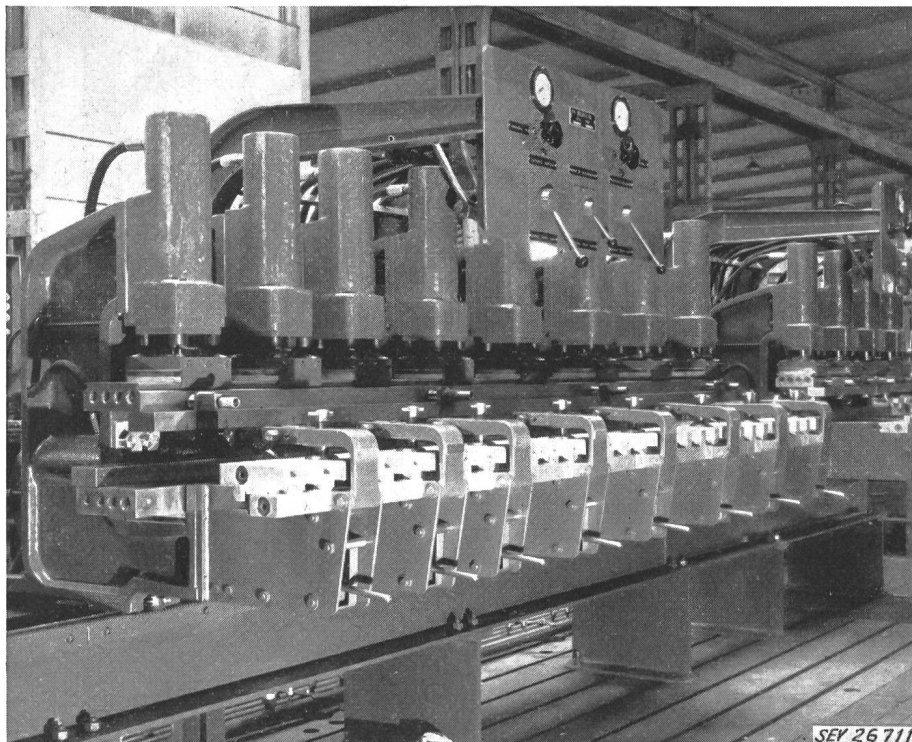
Fig. 2 Hydraulische Spulenausback- presse für Generatorstäbe, mit separater Kühlpresse Typ SPV h II-7500
