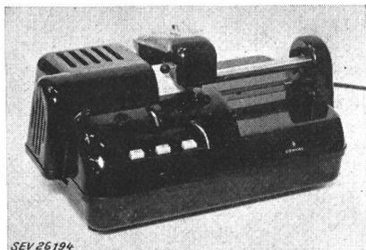
lateur et clavier de commande de l'appareil. Eléments montés sur un châssis logé dans un coffret en matière isolante moulée. Amenées de courant raccordées à demeure pour réseau électrique et téléphonique.
