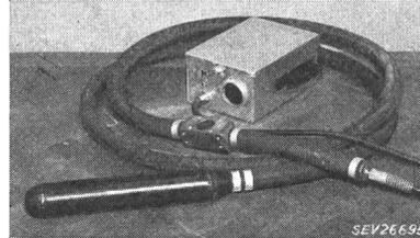
Ce pervibreur à béton a subi avec succès les essais relatifs à la sécurité. En liaison avec le transformateur de protection, il est conforme au «Règlement pour l'octroi du signe distinctif antiparasite» (Publ. n° 117 f). Utilisation: en plein air, avec un transformateur de protection conforme aux prescriptions.
