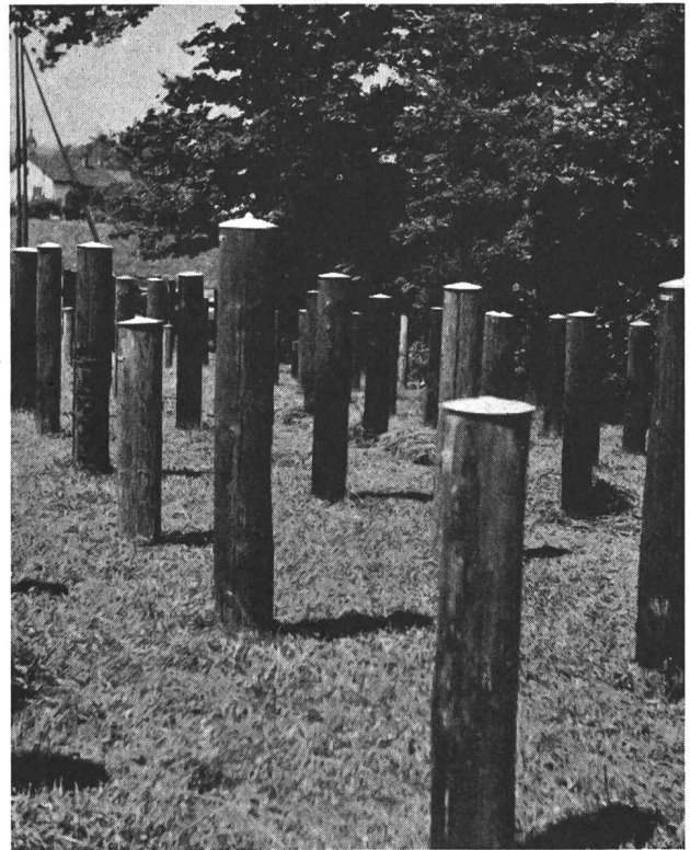
Fig. 27 Détail d'un des champs d'essai pour poteaux imprégnés près de Rathausen
