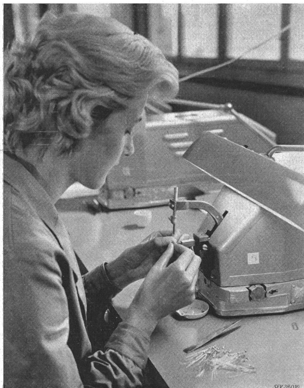
Fig. 3 Aufpunkten des Transistorelementes auf den Boden
