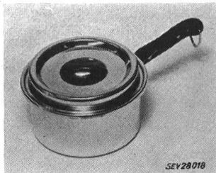
Le fond n'a subi qu'une faible déformation lors de l'essai. Ces casseroles sont donc appropriées à l'utilisation sur des plaques de cuisson électriques.
